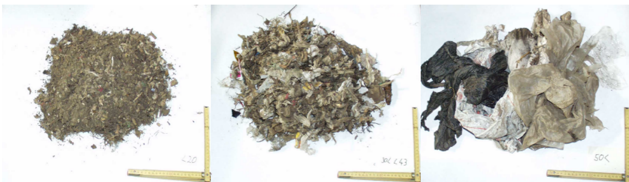
Abbildung 9 Siebfraktionen des dynamisch getrockneten Materials
